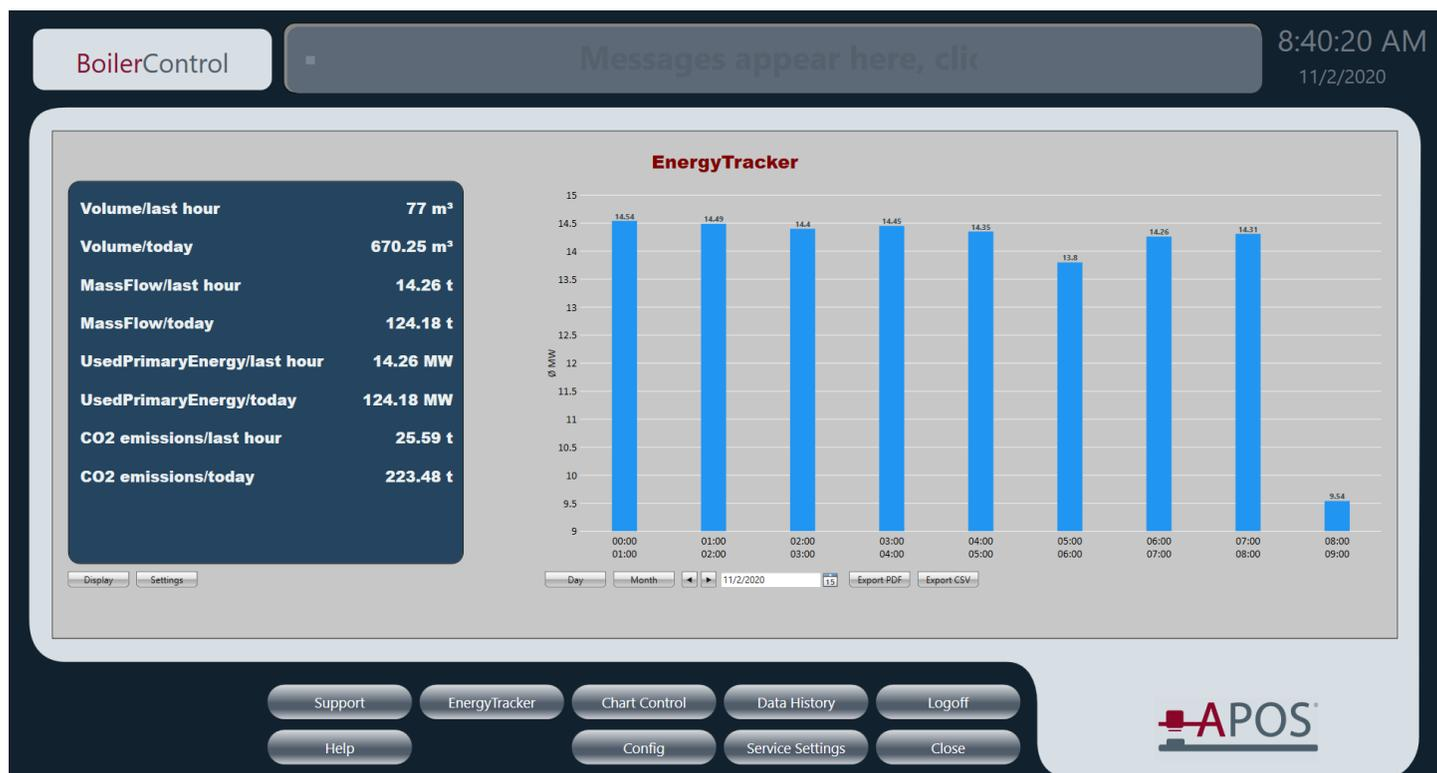
APOS BoilerControl EnergyTracker permet de déterminer facilement l'efficacité de la chaudière et de l'installation, ainsi que de surveiller votre process. Les paramètres pertinents pour les autorités, tels que l'énergie primaire, les émissions et l'efficacité de l'installation seront documentés automatiquement.
